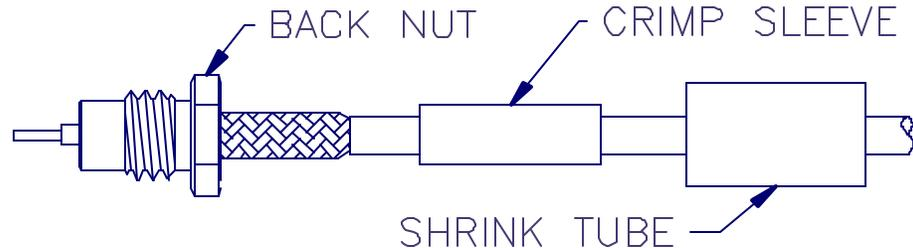
4. INSERT CABLE INTO TAIL-END OF BACK NUT, MAKING SURE TAIL GOES OVER DIELECTRIC AND UNDER BRAID. SLIDE IN UNTIL BRAID TOUCHES REAR SURFACE OF NUT.
