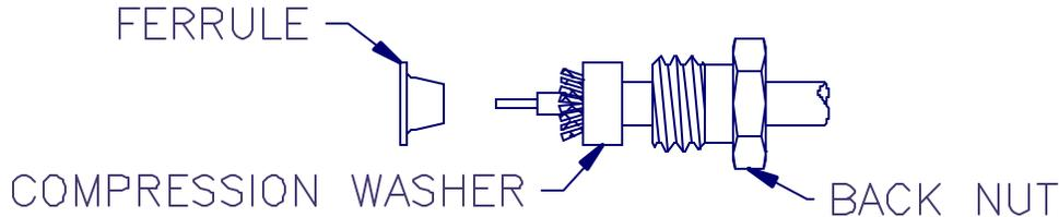
3. SLIDE COMPRESSION WASHER OVER THE BRAID UNTIL IT BOTTOMS OUT ON THE CABLE JACKET.
