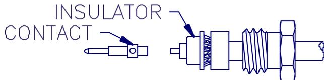
6. INSTALL SMALL INSULATOR OVER CABLE DIELECTRIC.
