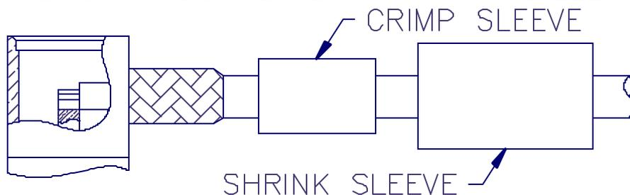
4. INSERT CABLE ASSEMBLY INTO BODY TAIL-END MAKING SURE TAIL GOES OVER DIELECTRIC AND UNDER BRAID. SLIDE IN UNTIL BRAID TOUCHES REAR SURFACE OF BODY.
