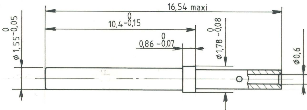
Matière et protection: contact: alliage de cuivre nickelé doré
