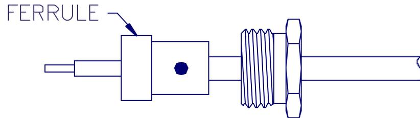
3. SLIDE FERRULE OVER CABLE DIELECTRIC UNTIL IT BOTTOMS ON THE CABLE JACKET.
