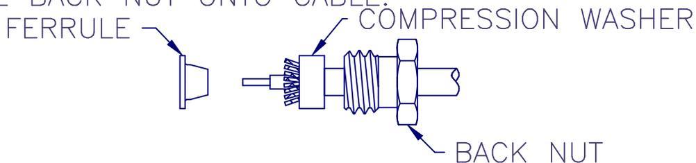
3. SLIDE COMPRESSION WASHER OVER BRAID UNTIL IT BOTTOMS ON CABLE JACKET. FAN OUT BRAID RADIALLY BY ROTATING THE CABLE DIELECTRIC.
