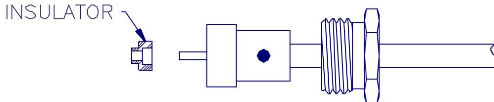
5. INSTALL SMALL INSULATOR OVER CABLE DIELECTRIC.
