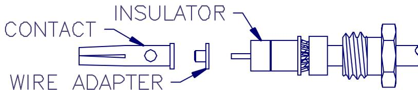
6. INSTALL SMALL INSULATOR OVER CABLE DIELECTRIC.
