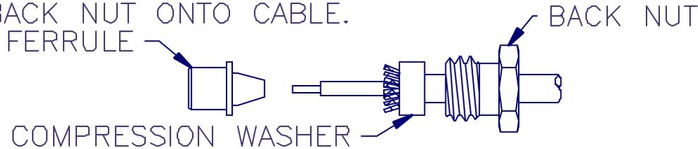
3. SLIDE COMPRESSION WASHER OVER THE BRAID UNTIL IT BOTTOMS OUT ON THE CABLE JACKET.
