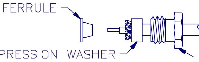
3. SLIDE COMPRESSION WASHER OVER THE BRAID UNTIL IT BOTTOMS OUT ON THE CABLE JACKET.
