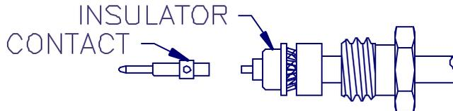
6. INSTALL SMALL INSULATOR OVER CABLE DIELECTRIC.
