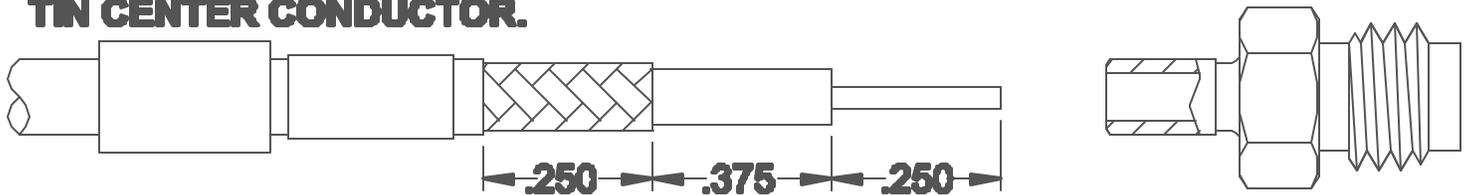
**2. INSERT NUT BETWEEN BRAID & DIELECTRIC UNTIL BRAID BUTTS AGAINST THE BACK SURFACE. SLIDE CRIMP SLEEVE FORWARD TO HEX SURFACE, CRIMP USING MIL-C-22520 TOOL, TRIM DIELECTRIC TO .040 TRIM CENTER CONDUCTOR TO .100 .**
