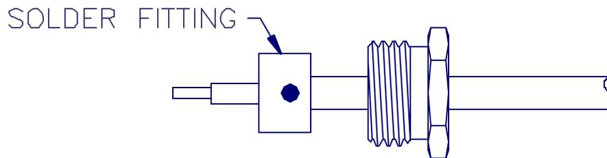
3. SLIDE SOLDER FITTING OVER CABLE DIELECTRIC UNTIL IT BOTTOMS ON THE CABLE JACKET.
